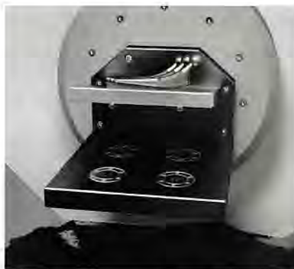
Bild 2: Anwender, die die AMF-Nullpunktschnittstelle in der Additiven Fertigung auf Folgeprozesse, wie z.B. das Reinigen „mitnehmen“, senken Rüstzeiten um über 90 Prozent
